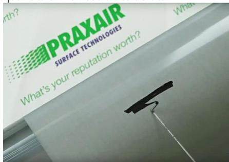
3. Una volta che l'inchiostro è stato applicato sulla superficie del rullo, il sistema di raclatura URMI, composto da una racla installata su un trattorino meccanico, viene utilizzato per distribuire uniformemente l'inchiostro.
