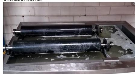
È necessario utilizzare solo soluzioni detergenti progettate per apparecchiature di lavaggio ad ultrasuoni specifiche per anilox ceramici.
